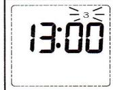
[逆洗回数]、[1回目の逆洗開始時刻]、[1回目の逆洗時間]を設定することにより、2回目以降の逆洗開始時刻と逆洗時間は、以下に示す通りに自動的に決定されます。(2回目以降の設定はできません。)
